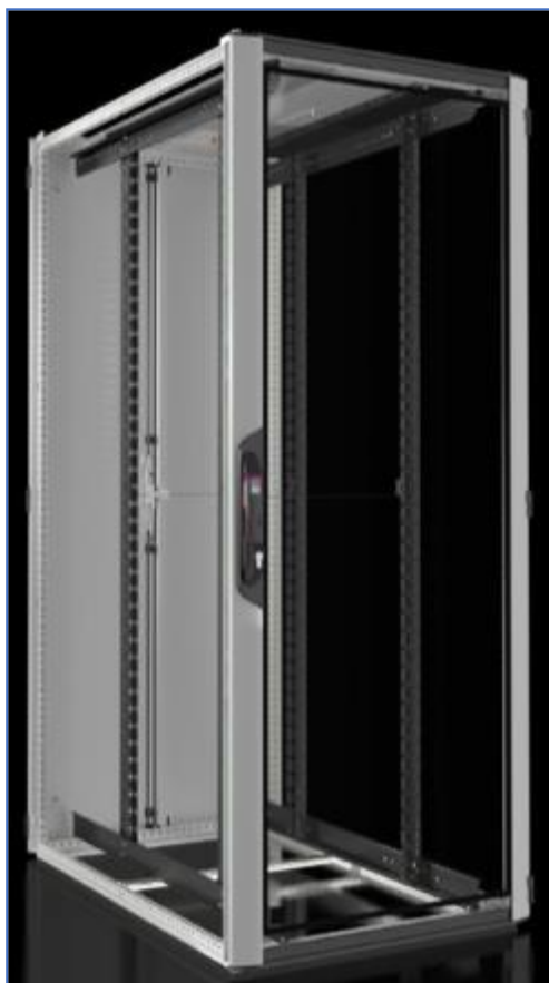
Slika 5 Primjer ormara za smještaj opreme - VX IT mreža, serversko i elektroničko kućište, varijanta "standard", IT rack, ugradbena visina 42U, ostakljena vrata sprijeda, dvodijelna, vrata od punog čeličnog lima straga
