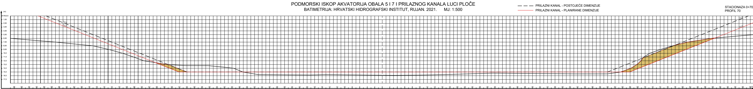
PODMORSKI ISKOP AKVATORIJA OBALA 5 I 7 I PRILAZNOG KANALA LUCI PLOČE - KARAKTERISTIČNI POPREČNI PRESJECI MJ. 1:500
